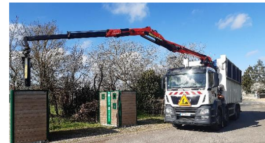
1 polybenne équipée d'une grue pour la collecte du verre
